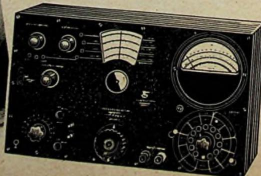
ser Einrichtung. Auch die Ontra-Werkstätten wenden das gleiche Prinzip an einer ähnlichen Brücke an; hier sitzt das magische Auge im Mittelpunkt einer Feinmeßskala, so daß Brückeneinstellung und Meßwert mit einem Blick abgelesen werden können. Dieses Gerät zeigt außerdem einen auswechselbaren Objekthalter, der ein sorgfältiges Vorbereiten jeder Messung gestattet.
